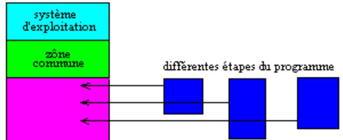
Un premier problème à régler est celui de la protection : il ne faut pas que deux zones d'information se chevauchent, en particulier, le programme utilisateur ne doit pas empiéter sur le système d'exploitation ; on utilise, pour cela, un registre "limites" :
